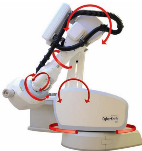
Rysunek 7. CyberKnife – stopnie swobody [34].
