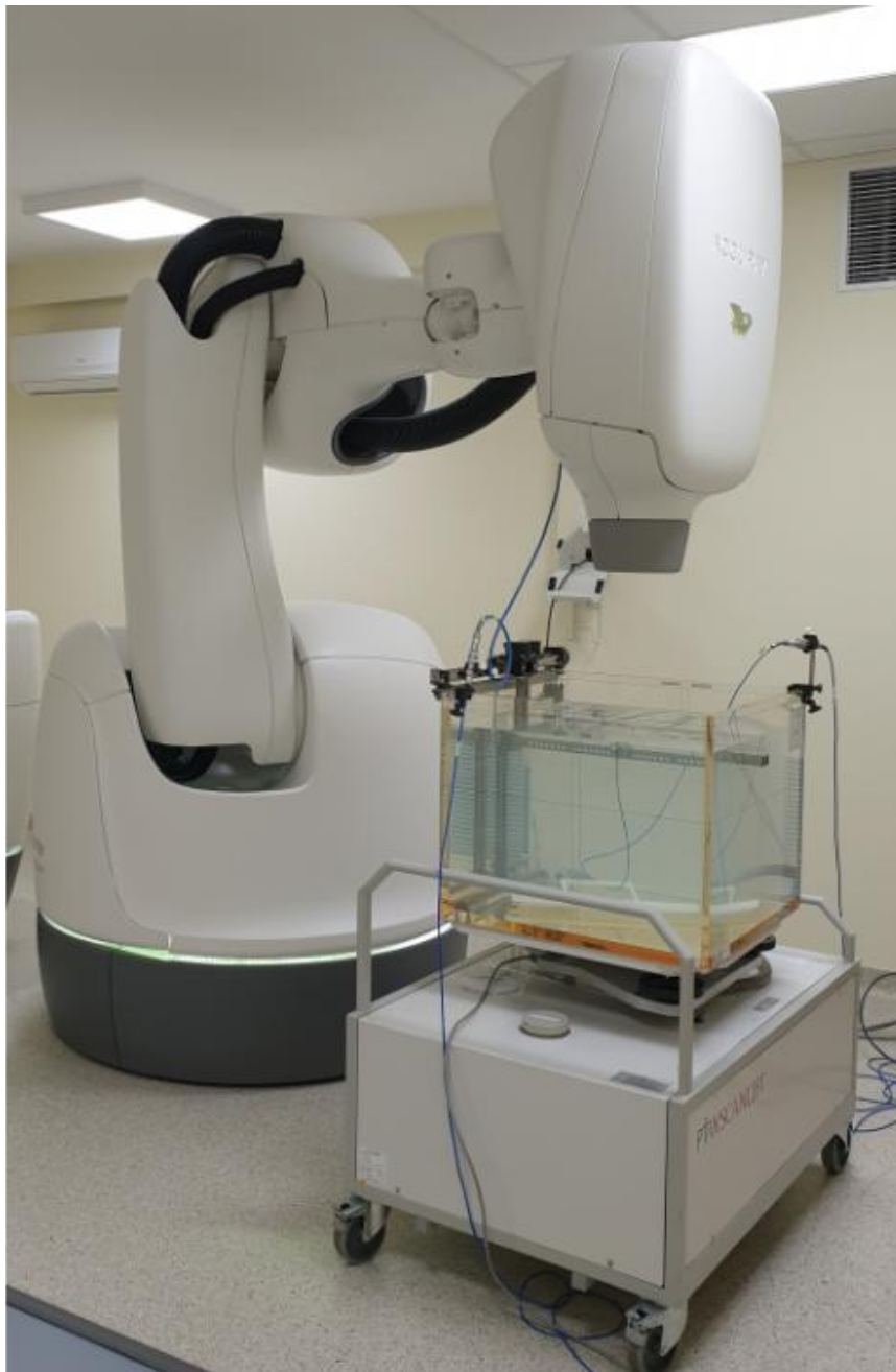
Rysunek 12. Urządzenie CyberKnife M6 z układem fantomowym MP3 dedykowanym do pomiarów rozkładów dawek w wodzie.
