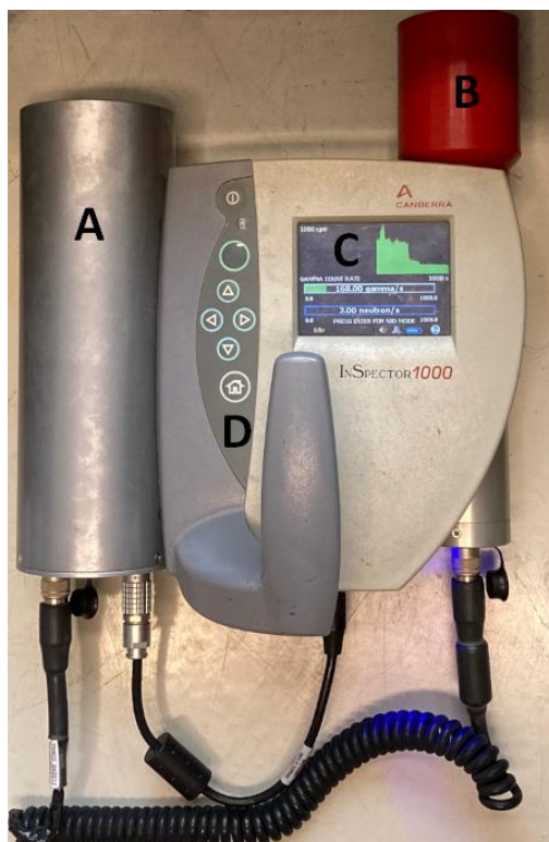
Rysunek 22. Zintegrowany system spektrometryczny InSpector 1000 firmy Canberra: A) przystawka neutronowa: ^3\text{He} -tube (komora helowa), B) sonda scyntylacyjna NaI, C) wyświetlacz LCD, D) panel sterujący.
