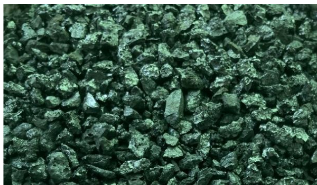
Rysunek 6. Węglik boru ( B_4C ) w postaci grudek o średnicy około 2 mm.
