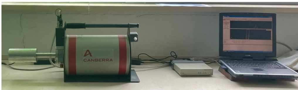
Rysunek 24. Zestaw pomiarowy składający się z półprzewodnikowego detektora germanowego HPGe, spektrometru InSpector 2000 oraz oprogramowania komputerowego GENIE 2000.
