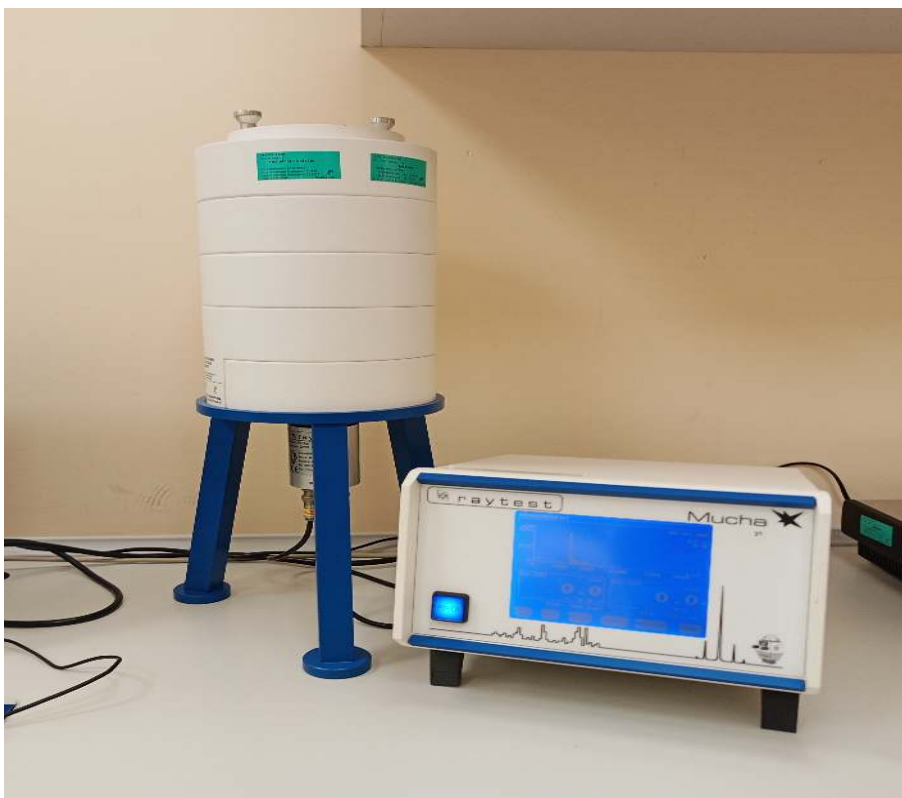
Rys. 9: Przykład detektora scyntylacyjnego z analizatorem. Zaprezentowany detektor nie wymaga dodatkowego chłodzenia i nadaje się do analizy próbek o wysokiej aktywności.
