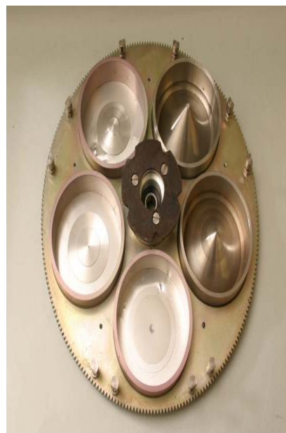
Rys. 4: Filtry wypłaszczające, umieszczone zwyczajowo na obrotowej karuzeli [6]
