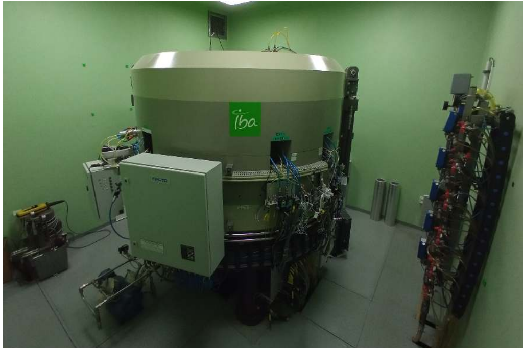
Rys. 5: Przykład cyklotronu firmy IBA Radiopharma, Cyclone 18/9, wykorzystywanego do produkcji np. izotopu ^{18}\text{F}
