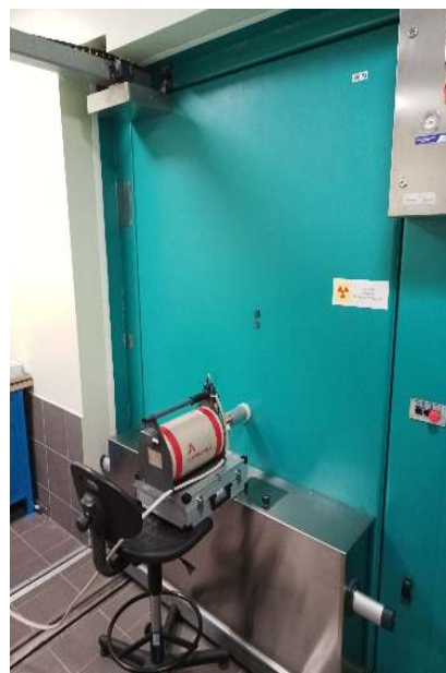
Rys. 36: Umiejscowienie detektora - pomiar promieniowania gamma przy drzwiach bunkra
