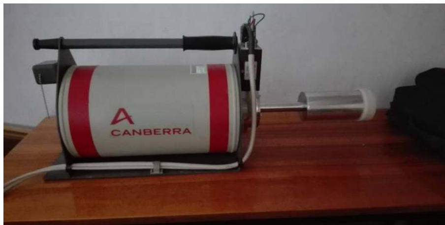
Rys. 10: Przykład detektora germanowego. Zaprezentowany spektroskop firmy Canberra posiada zbiornik na ciekły azot i nadaje się do badań środowiskowych, w przeciwieństwie do większości tego typu sprzętów, które zazwyczaj - z racji zabudowania zamkiem ołowianym i instalacją chłodzenia - są zbyt wielkie do transportowania.
