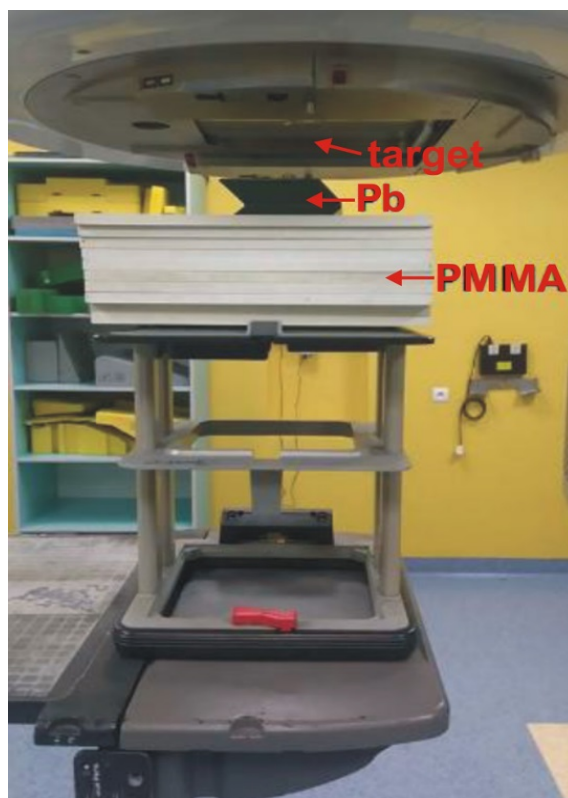
Rys. 26: Układ pomiarowy do aktywacji próbek renu i cyny
