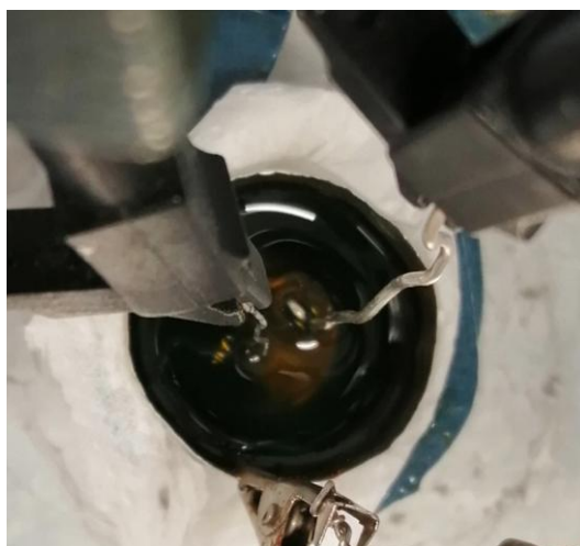
Zdjęcie 2. Zdjęcie zmontowanego zestawu do syntezy elektrochemicznej.
