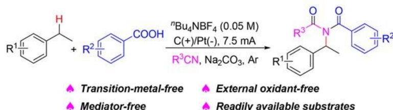
Schemat 44. Elektrochemiczna synteza imidów [132].
