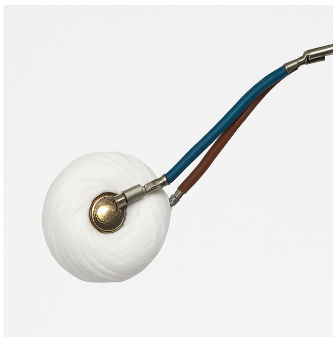
Rysunek 9. Kondensator pomiarowy do badań dielektrycznych w warunkach ciśnieniowych do 600 MPa.
