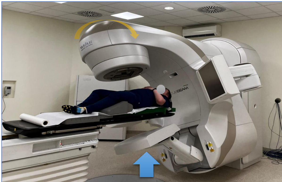
Rycina 8. Akcelerator liniowy TrueBeam, firmy Varian Medical Systems, w wyposażeniu, niebieską strzałką oznaczono detektor EPID AS1200 wykorzystywany do pomiarów. Źródło: materiały własne.
