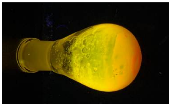
Fotografia 18. Postać związku PTE3-B w ciele stałym po wzbudzeniu promieniowaniem o długości fali 366 nm.
