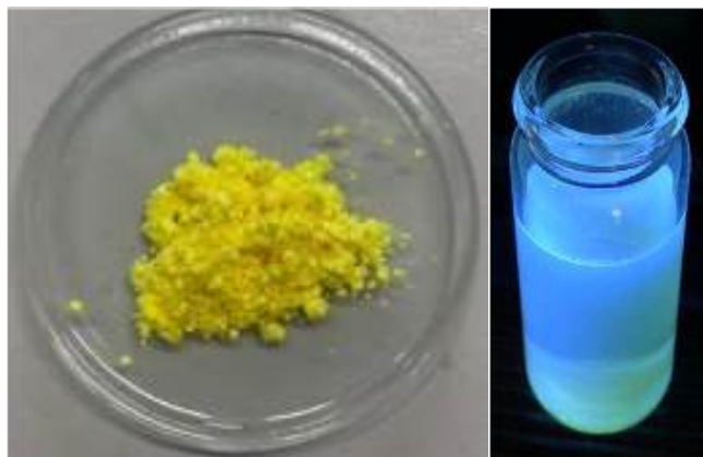
Fotografia 1. Postać otrzymanego nafto[ghi]peryleny. Po lewej: w ciele stałym, po prawej: w roztworze \text{CH}_2\text{Cl}_2 po wzbudzeniu promieniowaniem o długości fali 366 nm.
