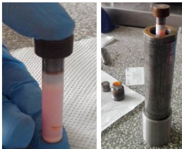
Fotografia 12. Teflonowa ampula (po lewej) oraz komora ze stali nierdzewnej (po prawej) do przeprowadzania reakcji pod wysokim ciśnieniem.
