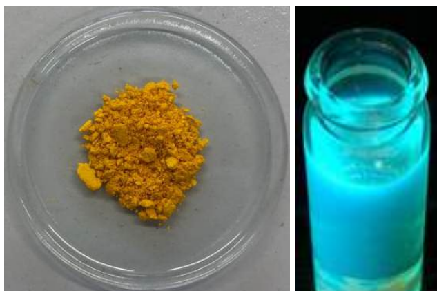
Fotografia 3. Postać otrzymanego antraceno[1,2,3,4-g]perylen ( Per2 ). Po lewej: w ciele stałym, po prawej: w roztworze CH_2Cl_2 po wzbudzeniu promieniowaniem o długości fali 366 nm.
