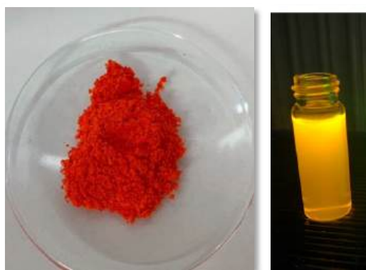
Fotografia 9. Postać otrzymanego produktu DAPI w ciele stałym (po lewej) i w roztworze chlorku metylenu po wzbudzeniu promieniowaniem o długości fali 366 nm (po prawej).
