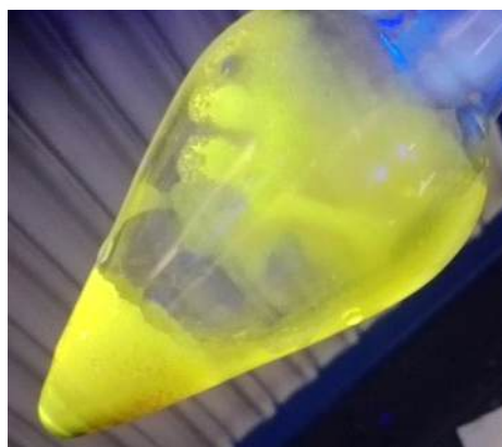
Fotografia 13. DAPI-A w ciele stałym, po wzbudzeniu promieniowaniem o długości fali 366 nm.
