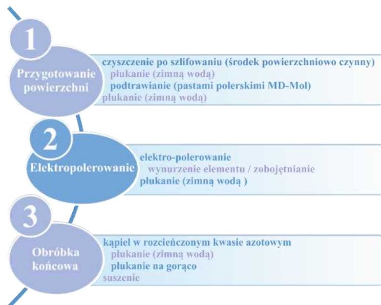
Rysunek 39. Schemat prawidłowego przebiegu procesu polerowania elektrolitycznego [opracowanie własne]
