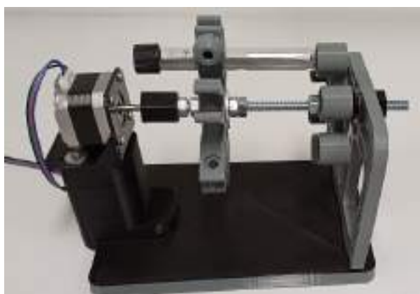
Rysunek 12. Zaprojektowane urządzenie do wstępnego mieszania odważonych proszków [Publikacje 2 – 4]
