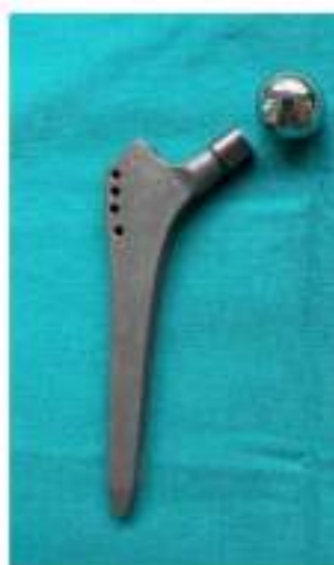
Rysunek 7. Endoproteza stawu biodrowego wytworzona ze stopu Ti-6Al-4V [70]
