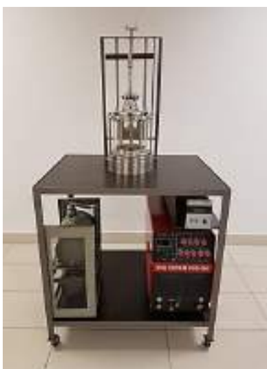
Rysunek 14. Piec do topienia łukowego wykorzystany do wytworzenia badanych materiałów w formie wlewków [Publikacje 1 – 4]
