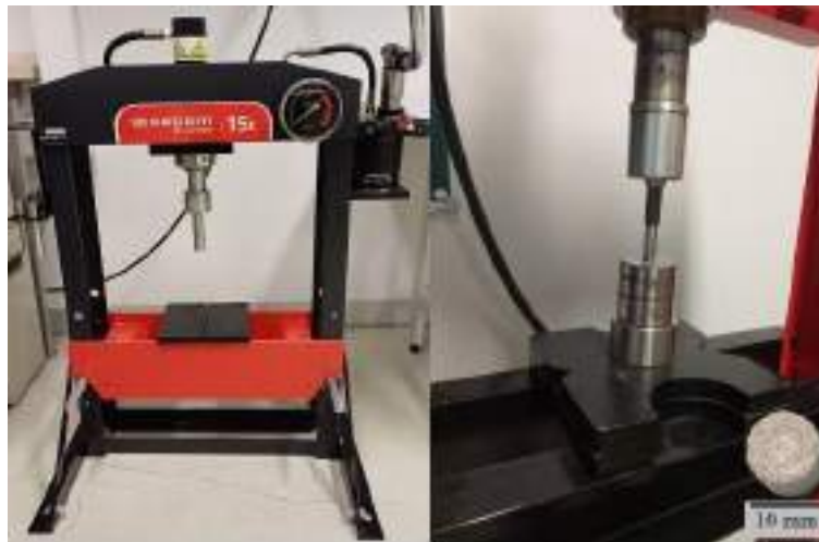
Rysunek 13. Prasa hydrauliczna, matryca o średnicy 10 mm wykorzystane w procesie prasowania wstępnie zmieszanych proszków oraz finalna wypraska [ Publikacje 2 – 4 ]
