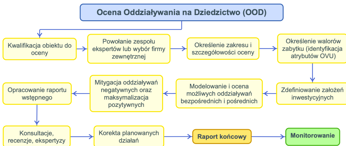
Ryc. 4. Schemat procedury oceny oddziaływania na dziedzictwo, opracowanie własne w oparciu o wytyczne ICOMOS ( Guidance on Heritage Impact Assessments... , 2011)
