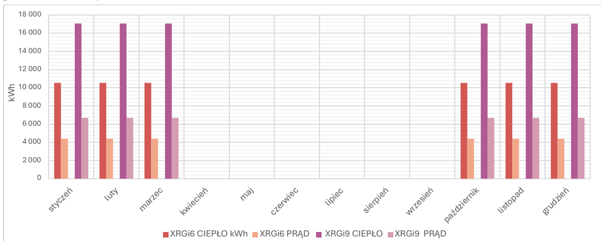
Ryc. 69. Porównanie wydajności układów kogeneracyjnych XRGi6 i XRGi9 w miesiącach zimowych (wg. założeń J. Gładysza)
