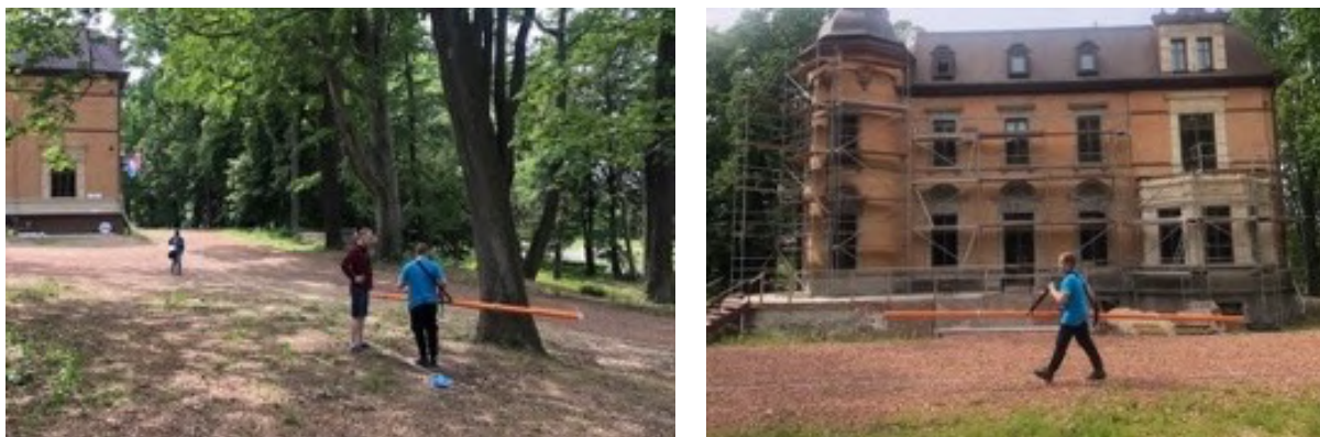
Fot. 86. i 87. Pomiary konduktometryczne wokół palacu od strony północno-zachodniej i południowo-wschodniej (E. Mackiewicz)
