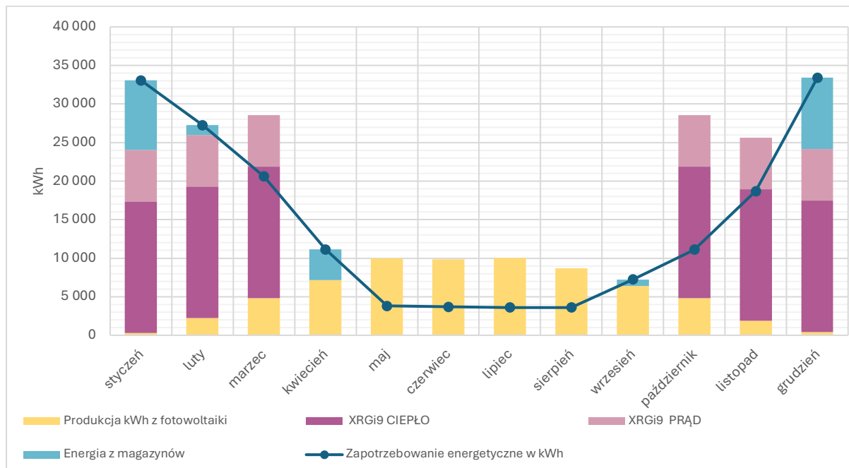
Ryc. 70. Symulacja miksu energetycznego z wykorzystaniem agregatu XRGi9
