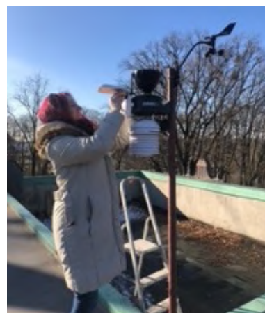
Fot. 91. i 92. Lokalizacja stacji na dachu pałacu (E. Mackiewicz); montaż stacji Vantage PRO2 (M. Dronszyk)
