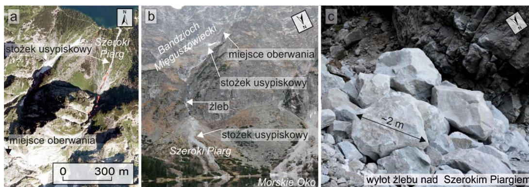
Ryc.10. Obliczone i obserwowane miejsca depozycji 8-tonowych bloków skalnych uwolnionych z Turni Kurczaba w dniu 22 października 2021 r.; a) czerwone kropki: prawdopodobne miejsca zatrzymania bloków skalnych (ortofotomapa 2009: Główny Urząd Geodezji i Kartografii); b) system stokowy Turni Kurczaba: w obrębie żlebu i w rynnie spływu gruzowego w środkowej części dolnego stożka usypiskowego widoczny świeży materiał skalny (zdjęcie wykonane 28.10.2021 r.: Z. Rączkowska); c) kształt i wielkość bloków skalnych zdeponowanych w najwyższej części Szerokiego Piargu (zdjęcie wykonane 28 października 2021 r.: Z. Rączkowska).
