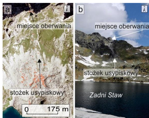
Ryc.12. Obliczone i obserwowane miejsca depozycji 8-tonowych bloków skalnych uwolnionych z Niebieskiej Turni w dniu 21 maja 2018 r.; a) czerwone kropki: prawdopodobne miejsca zatrzymania bloków skalnych (ortofotomapa 2009: Główny Urząd Geodezji i Kartografii); b) system stokowy Niebieskiej Turni: w górnej części stożka usypiskowego widoczny świeży materiał skalny, w środkowej części i niżej widoczne są także pojedyncze duże bloki skalne (zdjęcie wykonane 22.05.2018 r.: M. Szumny).
