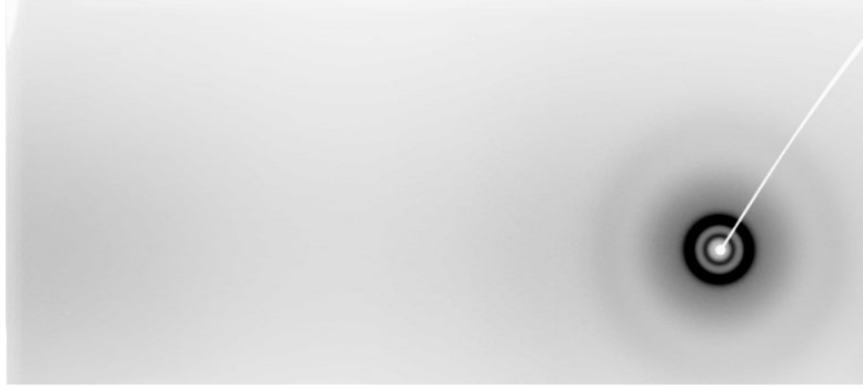
Rys. 3. Dwuwymiarowy obraz dyfrakcyjny (isobutanol) otrzymany za pomocą laboratoryjnego dyfraktometru.
