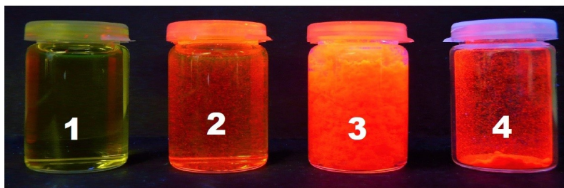
Zdjęcie 2. Przykład obrazujący zjawisko emisji wzmocnionej poprzez agregację (przykład dla pochodnej 24 ). 1) roztwór o stężeniu 1 \times 10^{-5} mol/L w THF; 2) roztwór o stężeniu 1 \times 10^{-5} mol/L w mieszaninie THF:woda 1:4; 3) roztwór o stężeniu 1 \times 10^{-5} mol/L w mieszaninie THF:woda 1:9; 4) jako ciało stałe. Zdjęcie wykonano podczas naświetlania światłem o długości 365 nm.
