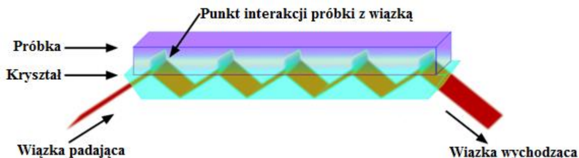
Rysunek 38. Interakcja wiązki podczerwieni z próbką po wprowadzeniu za pomocą techniki ATR [161].
