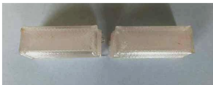
Rysunek 46. Próbka poliwęglanu z betuliną bezpośrednio po przeprowadzonej próbie udarności.
