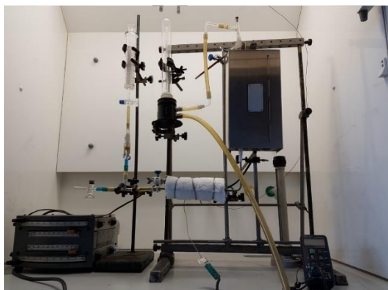
Rys.2. Schemat aparatury pomiarowej do pomiarów aktywności katalitycznej: 1 – mieszanki gazowe; 2 - przepływomierz; 3 - czujnik temperatury; 4 - piec reaktora; 5 - złożo katalizatora; 6 - reaktor przepływowy; 7 - chromatograf gazowy SRI Instruments 310
