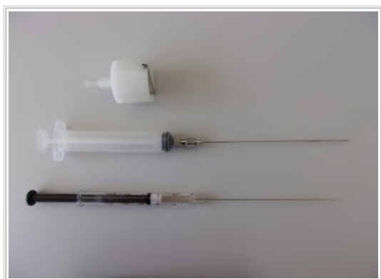
Rysunek III.8. Zestaw potrzebny do prawidłowego nałożenia próbki: a) lejek, b) strzykawka z pierścieniem do wyrównywania poziomu cieczy w odprowadzeniach kapilarnych (Rys. III.9), c) strzykawka Hamilton z igłą odpowiedniej długości o tępej końcówce do nakładania próbek.
