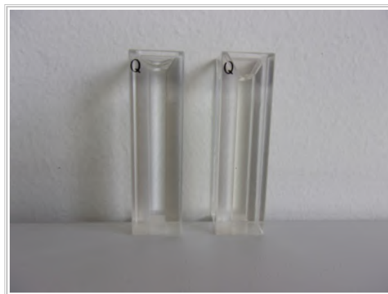
Rysunek III.15. Mikrokuwety kwarcowe – referencyjna wypełniona wodą i pomiarowa wypełniona roztworem surowicy krwi ludzkiej.
