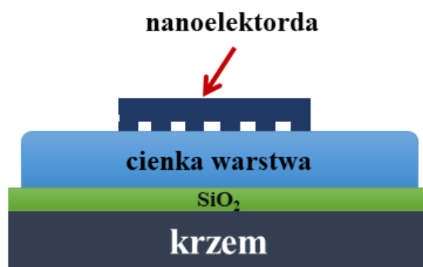
Rysunek 5.6. Schemat kondensatora stosowanego do dielektrycznych pomiarów cienkich warstw.
