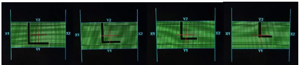
Rysunek 104. Pola utworzone na akceleratorze przez listki w celu wykonania testu FOURL (fotografia własna).
