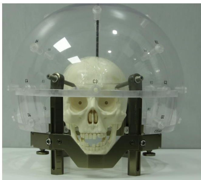
Rysunek 31. Akrylowa półkula z narzędziem pomiarowym (źródło własne).
