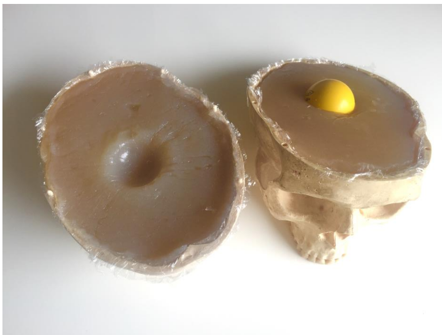
Rysunek 24. Fantom własny wypełniony roztworem agarowym użyty w celu napromieniania detektorów żelowych. Po prawej stronie widoczny detektor żelowy umieszczony w dolnej części czaszki (źródło własne).
