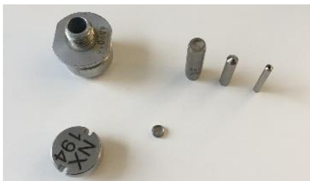
Rysunek 7. Fotografia kapsulek i docelowego pojemnika, w którym umieszczane są granulki źródła ^{60}\text{Co} (źródło własne).
